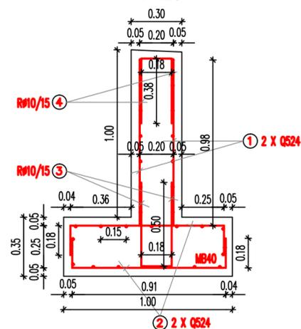
SPECIFIKACIJA ARMATURE BETONSKOG ZIDA
