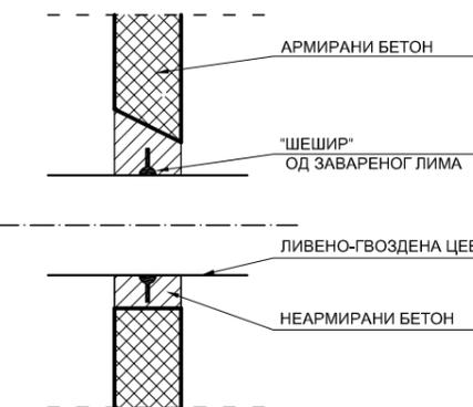
НАПОМЕНА: МОНТАЖА ЛИВЕНО-ГВОЗДЕНЕ ЦЕВИ КОЈА ПРОЛАЗИ КРОЗ ЗИД ОБЈЕКТА ВРШИ СЕ ПО БЕТОНИРАЊУ ДОЊЕ ПЛОЧЕ ОБЈЕКТА, А ПРЕ ПОСТАВЉАЊА ОПЛАТЕ И БЕТОНИРАЊА ЗИДОВА
